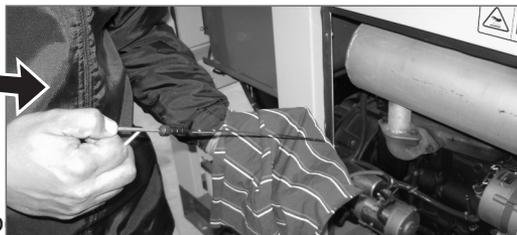
9) Dê partida e deixe o motor funcionando por um tempo para atingir a temperatura normal de trabalho. Enquanto isto verifique se não há vazamento de óleo.
